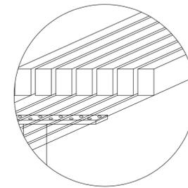
DETALLE DE LA SUJECCION DE LOS LISTONES CON LA PLETINA MEDIANTE TORNILLOS DE ACERO INOXIDABLE.
